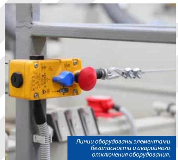
Линии оборудованы элементами безопасности и аварийного отключения оборудования.
