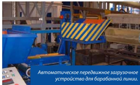
Автоматическое передвижное загрузочное устройство для барабанной линии.
