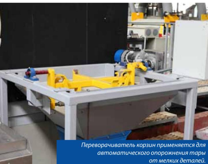
Переворачиватель корзин применяется для автоматического опорожнения тары от мелких деталей.
