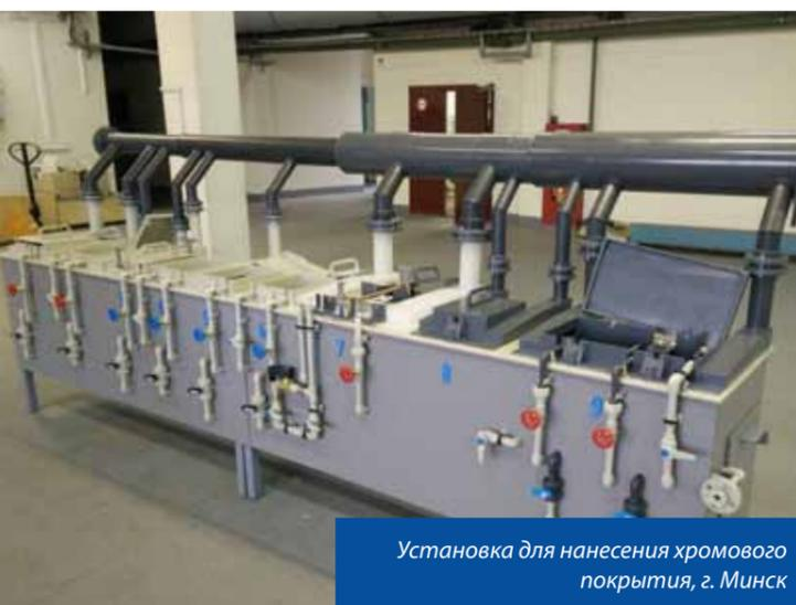
Установка для нанесения хромового покрытия, г. Минск
