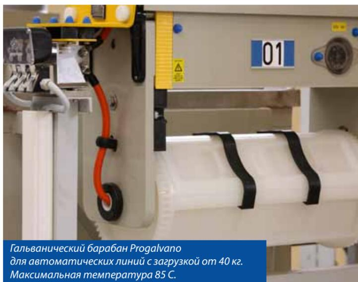
Гальванический барабан Progalvano для автоматических линий с загрузкой от 40 кг. Максимальная температура 85 С.
