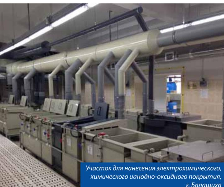
Участок для нанесения электрохимического, химического и анодно-оксидного покрытия, г. Балашиха
