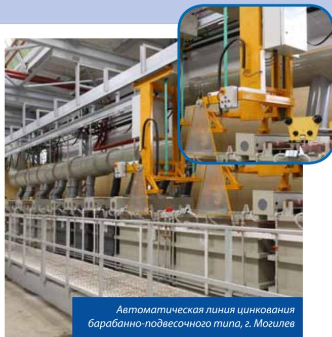
Автоматическая линия цинкования барабанно-подвесочного типа, г. Могилев
