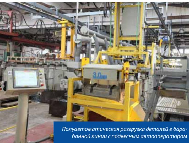
Полуавтоматическая разгрузка деталей в барабанной линии с подвесным автооператором
