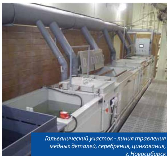
Гальванический участок - линия травления медных деталей, серебрения, цинкования, г. Новосибирск
